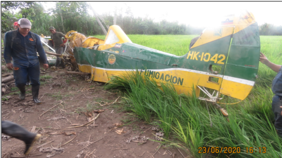
Fotografía No. 7 – Desensamble y remoción de la aeronave desde el sitio del accidente.
