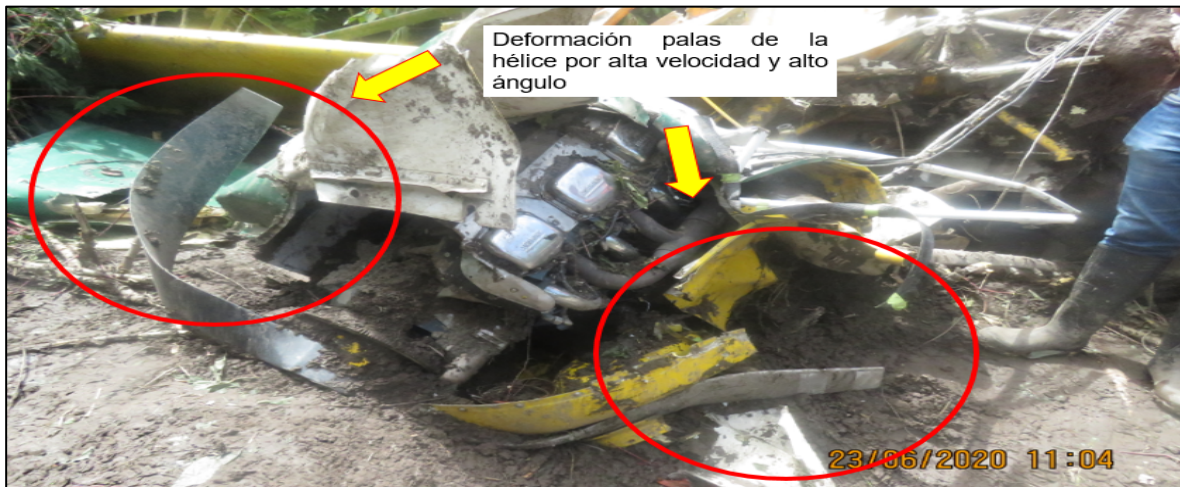
Fotografía No. 5 – Daños en las palas de la hélice.
