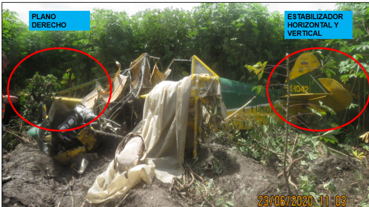
Fotografía No. 6 – Estado completo del plano derecho y del empenaje.
